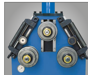
Speciální boční vodičí kladky pro úhlové zakružování
