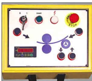
Digitální odměřování zadního válce (volitelné příslušenství)
