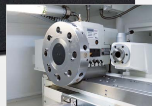
▶ Hydraulický výměník nástrojů VDI30 pro osm nástrojů
