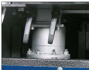
Boční kladky je možné zajistit ve zvolené poloze pomocí dvou pák.
