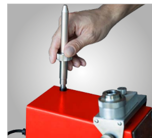
► Doraz pro nastavení správné délky broušení
