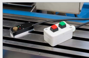
Senzor pro měření délky nástroje / tlačítko START/STOP
