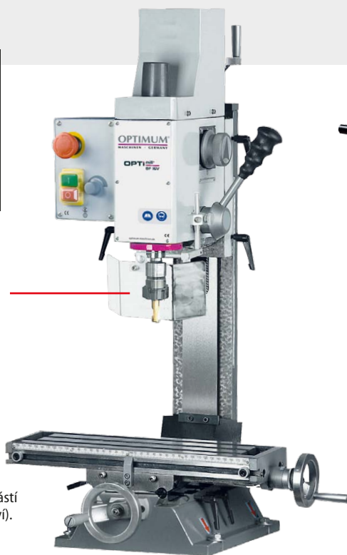
Sloup stranově přestavitelný o \pm 30 mm
