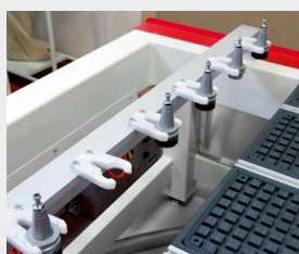
► Lineární zásobník na 6 nástrojů, upínače ISO30
