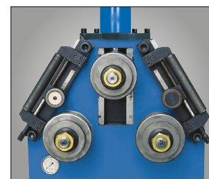
Speciální boční vodicí kladky pro úhlové zakružování
