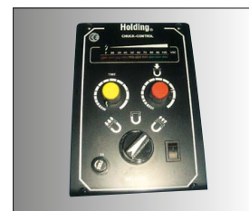
► Automatické zařízení pro odmagnetizování obrobku
