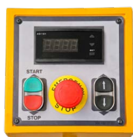
Ovládací pult s digitálním odměřováním
